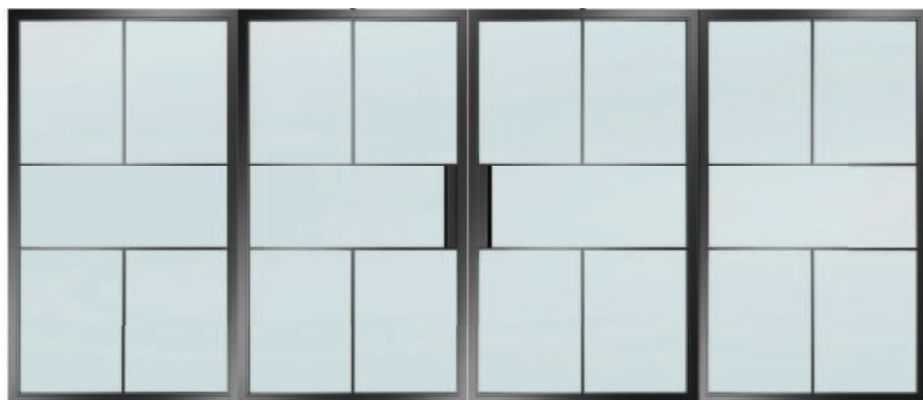
2-flügelige Pivottür mit 2 Seitenteilen und Motiv 2, Glashalteleiste Slim
