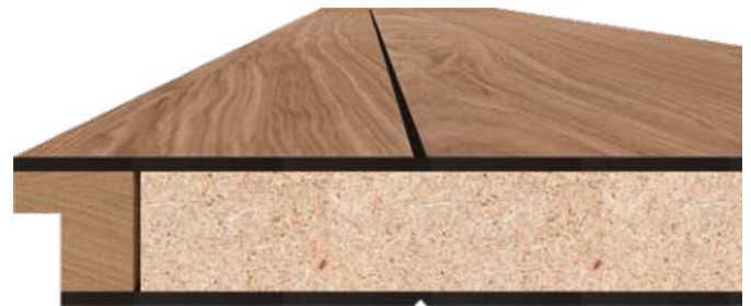
Schnitt Nero, Alternativeinlage VSP
