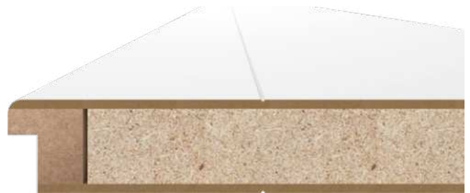
Schnitt Gap, Alternativeinlage VSP
