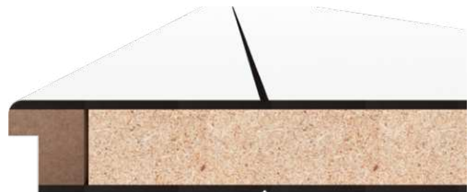
Schnitt Nero, Alternativeinlage VSP
