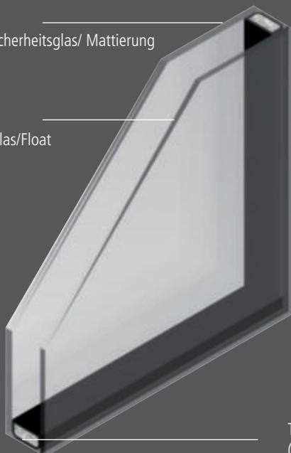
3-FACH-VERGLASUNG =  $U_g 0,6 \text{ W/m}^2\text{K}$
