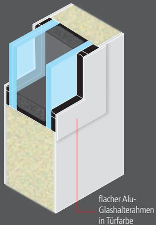
Alle Türen verfügen über optimiertes Wärmeschutz- und Verbundsicherheitsglas mit thermisch verbessertem Randverbund (warme Kante).
