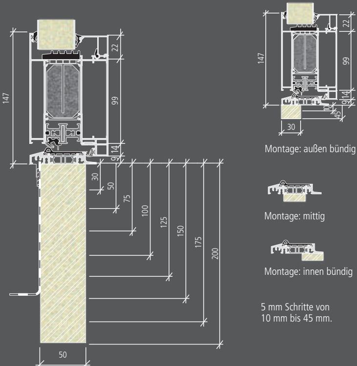
Gegen Mehrpreis erhalten Sie die **Neubaubodenschwelle** mit Bodeneinstand ab 30 mm, auf Wunsch auch mit Bauanschlussfolie.
