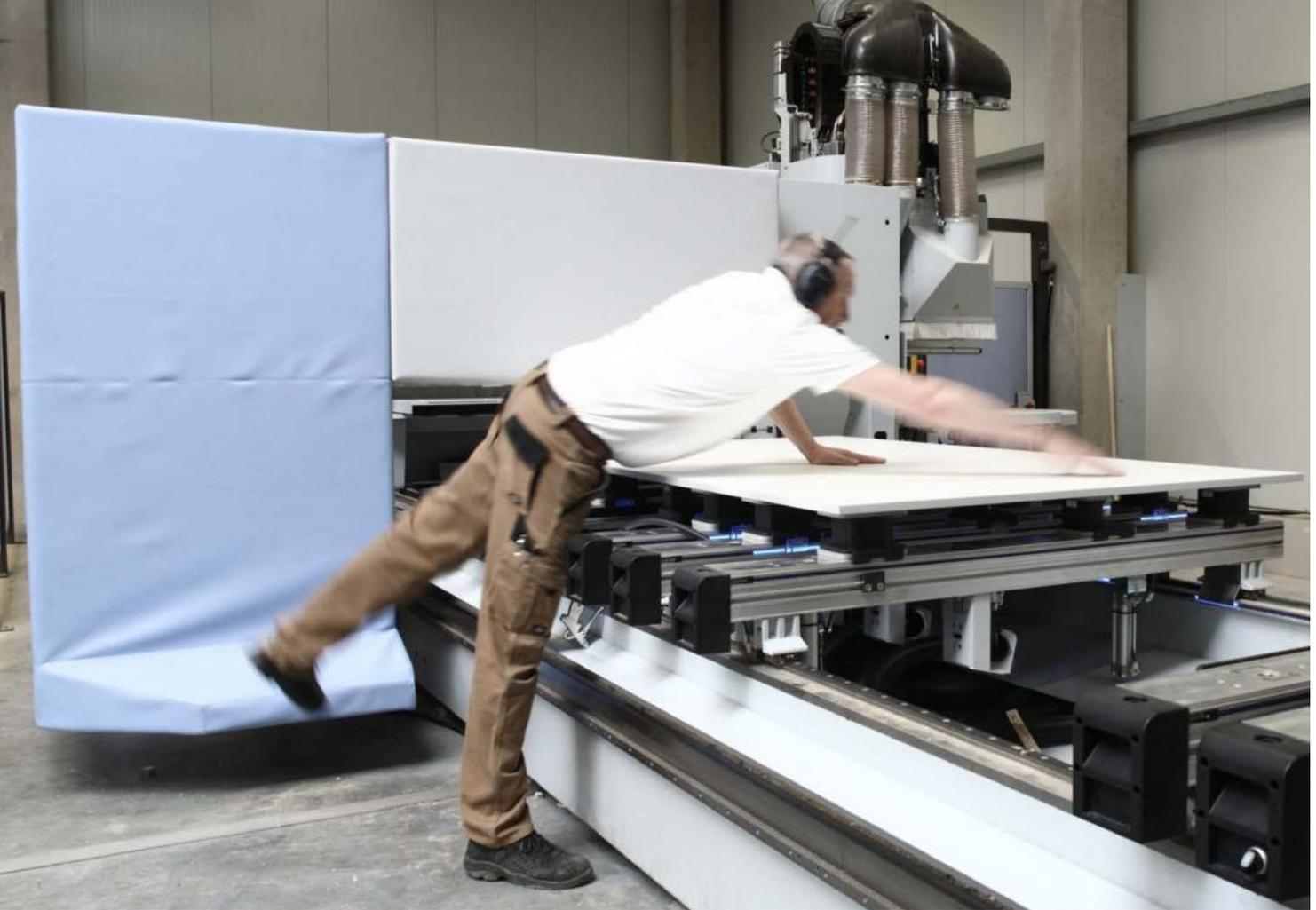
Im Bereich „Bohren und Fräsen“ werden alle konstruktiven Bearbeitungen wie Bohrungen, Lochreihen, Nuten, Taschen, eingeleimte Dübel und Freiformfräsungen ausgeführt.
