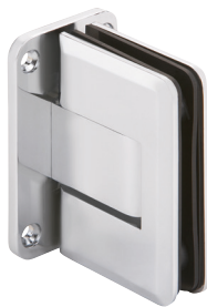
Pendeltürbeschlag Agita für GGT 8mm, Edelstahl matt Flügelgewicht bis zu 60 kg und Breite 915 mm (links) Flügelgewicht bis zu 100 kg und Breite 1200 mm (rechts)
