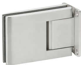
Pendeltürbeschlag Agita für GGT 8mm, Edelstahl matt Flügelgewicht bis zu 60 kg und Breite 915 mm (links) Flügelgewicht bis zu 100 kg und Breite 1200 mm (rechts)
